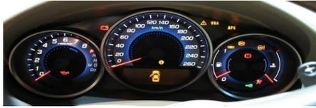
C'est un ensemble d'indicateurs et de témoins qui renseignent le conducteur d'un véhicule sur le fonctionnement du moteur et sur les paramètres de conduite. Il est situé face au conducteur.
